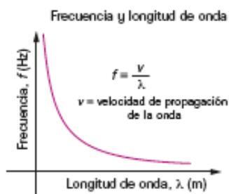
Según la expresión que se muestra en la segunda gráfica, la frecuencia,  $f$ , y la longitud de onda,  $\lambda$ , son inversamente proporcionales, pues el producto de ambas magnitudes siempre es igual a la velocidad de propagación de la onda,  $v$ , valor que es siempre positivo. Así pues, se trata de una función de proporcionalidad inversa decreciente.
