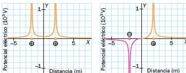
En la primera gráfica figura el potencial eléctrico en torno a dos cargas positivas e iguales. En ella puede observarse cómo la mitad izquierda de la gráfica se obtiene al voltear o reflejar la mitad derecha con respecto al eje vertical. Se trata, por tanto, de una función par, es decir, simétrica respecto del eje de ordenadas, OY, verificándose que  $f(-x) = f(x)$ .
